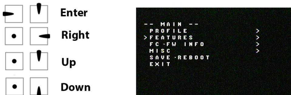
Figure 9 - Commande pour pilotage du menu l'OSD (radio mode 2)
